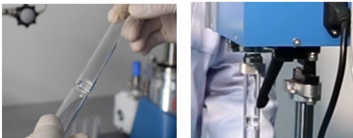
图 4-5 石英柱及管接头安装示意图
