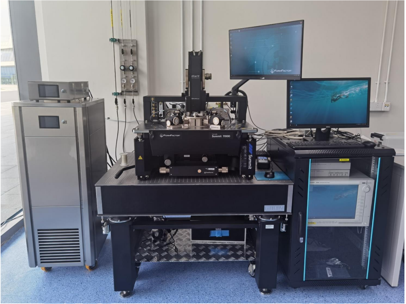
图 6.1 高低温探针电学光电测量系统
