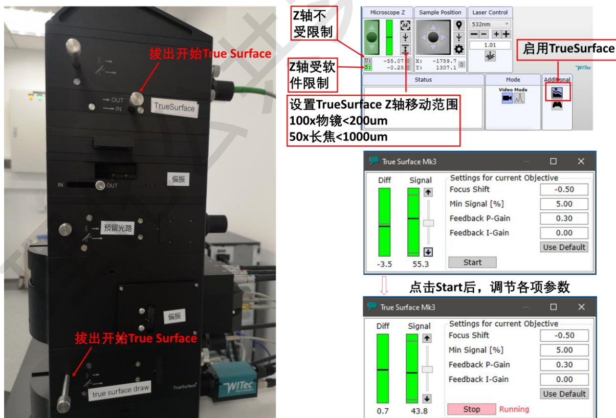
图 4-17 TrueSurface 成像的参数设置
