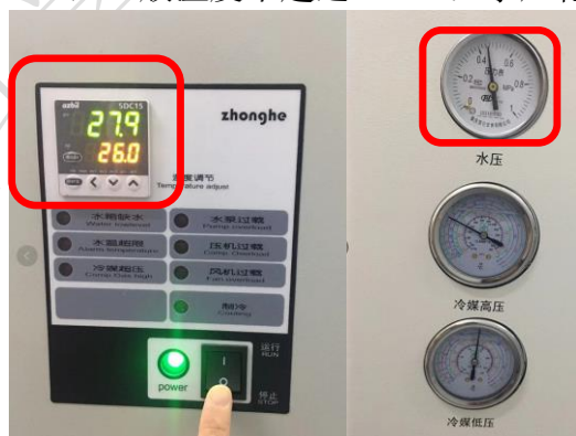
图 6-5 水冷机温度及水压示意图
