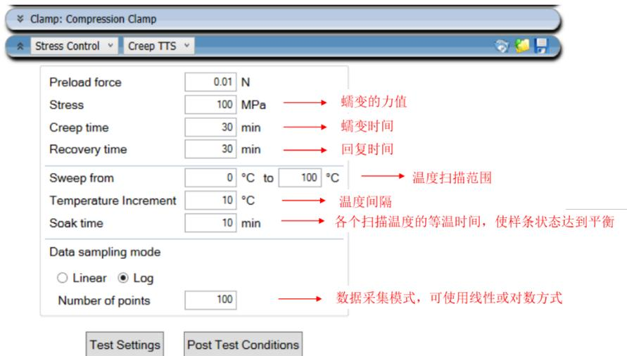
图 4-28 蠕变 TTS 测试界面
